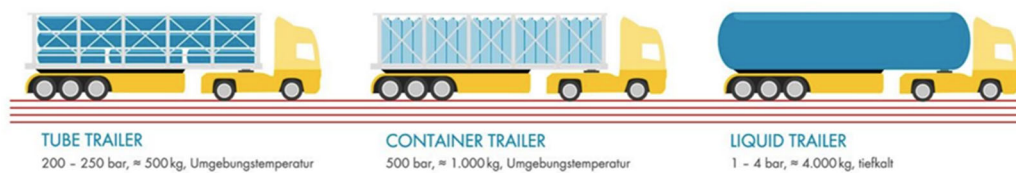
Abbildung 19 Transportmöglichkeiten von Wasserstoff 1
